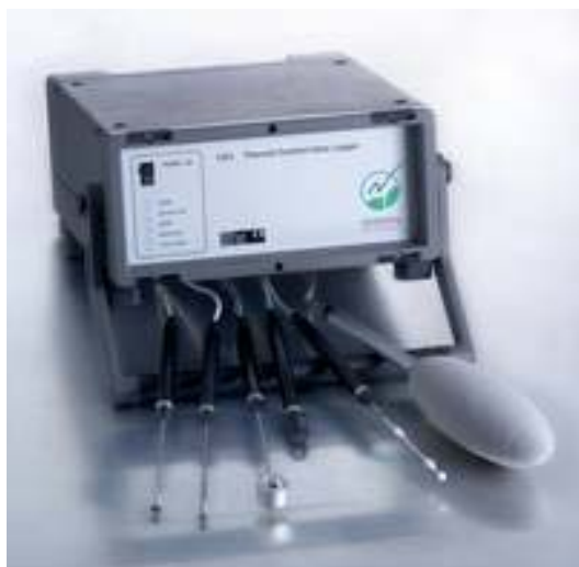
Obr. 1.6 Multifunkční měřicí zařízení pro měření tepelného komfortu [12]
